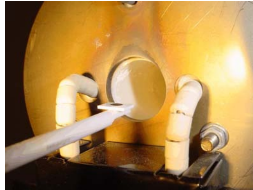
fig. 10: Uscita del provino dal forno
