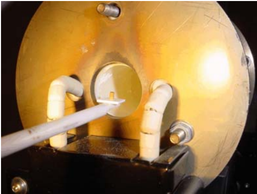
fig. 9: Ingresso del provino in forno
