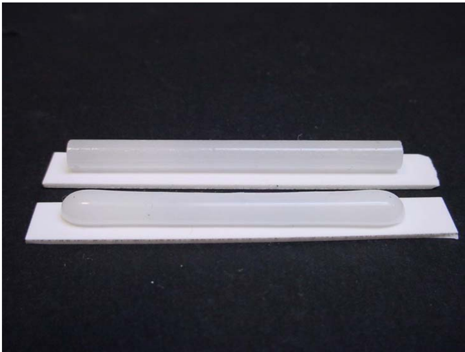
Fig. 4: Muestras de vidrio antes y después de la medición con MISURA LT dilatómetro óptico.
