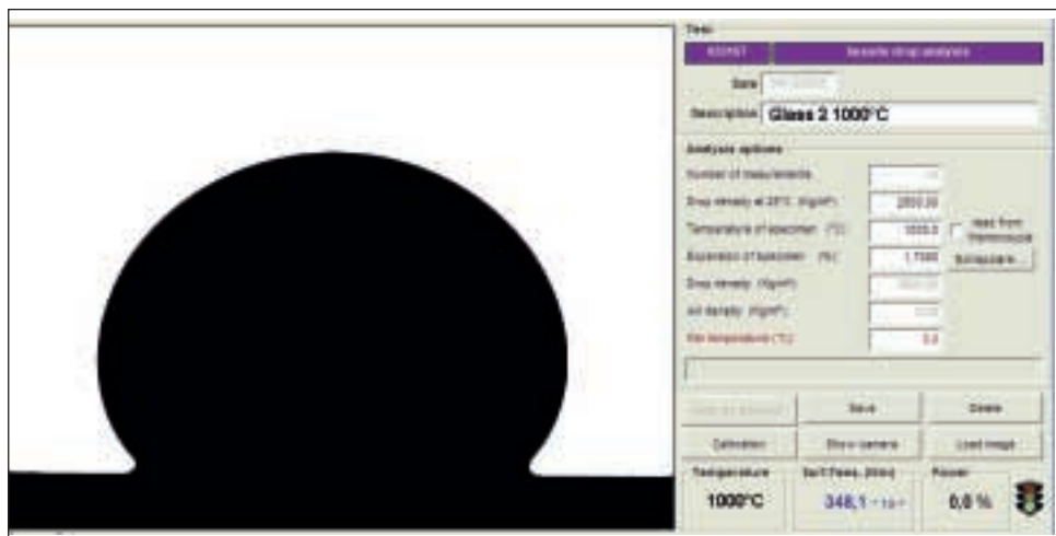
Fig. 11 - Misura della tensione superficiale di un vetro a 1000°C.
