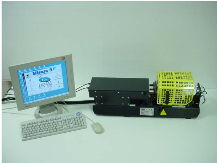
Il nuovo dilatometro ottico orizzontale MISURA LT
